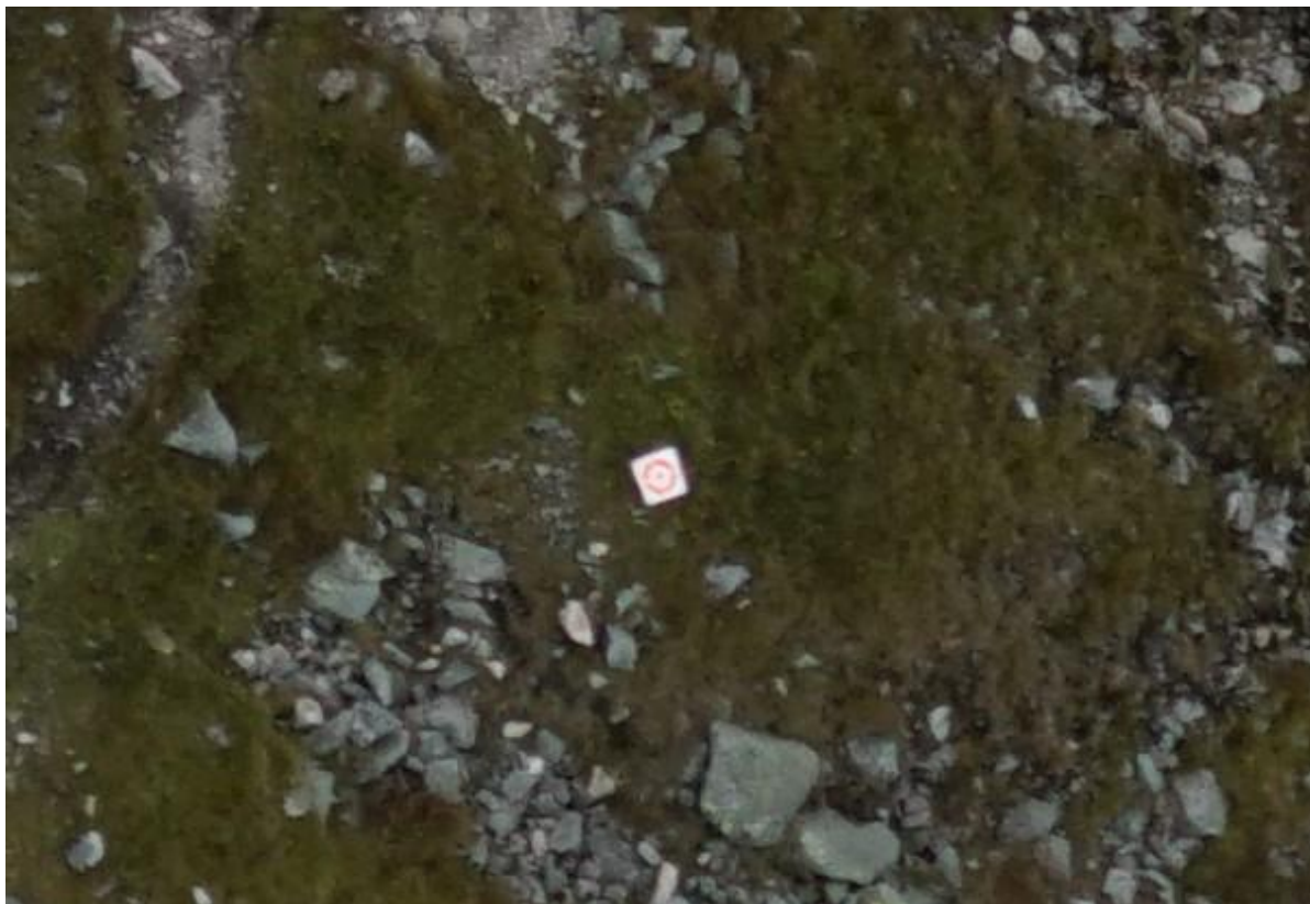
Rysunek 1. Sztuczny fotopunkt na zdjęciu wykonanym z UAV (okolice Kasprowego Wierchu)
